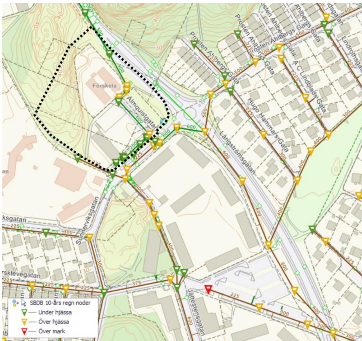
Figur 11 Maximala vattennivån i ledningsnätet vid ett 10-årsregn med klimatfaktor 1,25. Röda noder markerar risk för marköversvämning och gula noder är vattennivå över hjässa.
